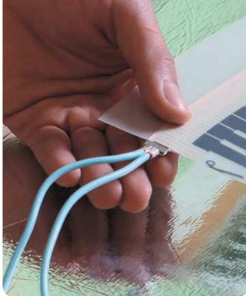
Рис. 15. Соединение монтажных проводов с контактным зажимом
