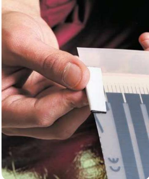
Рис. 14. Окончание процесса изолирования линии отреза медной шины
