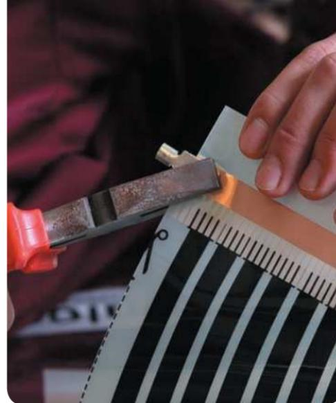
Рис. 10. Крепление контактного зажима к термопленке
